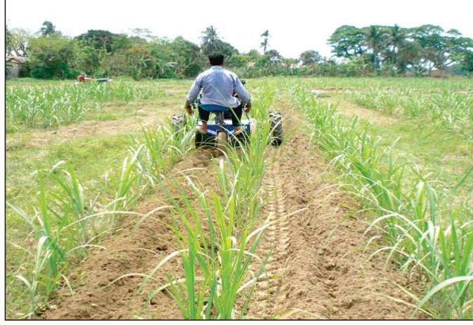
আখ ক্ষেতে বিএসআরআই পাওয়ার চালিত উইডার ব্যবহার হচ্ছে
